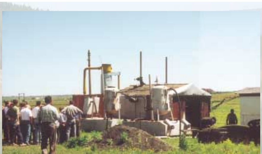
Foto 2 : Primitieve affakkelininstallatie voor het onttrekken van CH 4 uit koolmijnen (Kusbas regio, Siberië).
